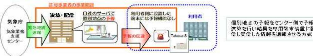
気象庁の技術改革等で演算方式等が改定されても専用端末装置とは関係なく、センター側のサーバー等の更新のみで、対応可能に工夫されています。その結果、常時最新のシステム構成を維持しながら、端末装置の負担を軽減し、最新システムでの稼働を可能にしています。個別地点の端末装置の常時運用も、常時遠隔で維持管理、メンテナンスもセンター側で一括監視可能。「弊社の場合は配信方法が他社と違い独自配信方法を採用。」(特許)
